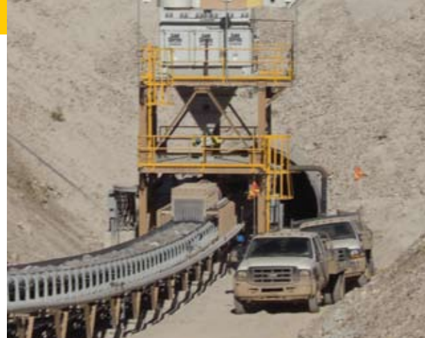
Un GS en un punto de transferencia de alimentador-a-transportador
