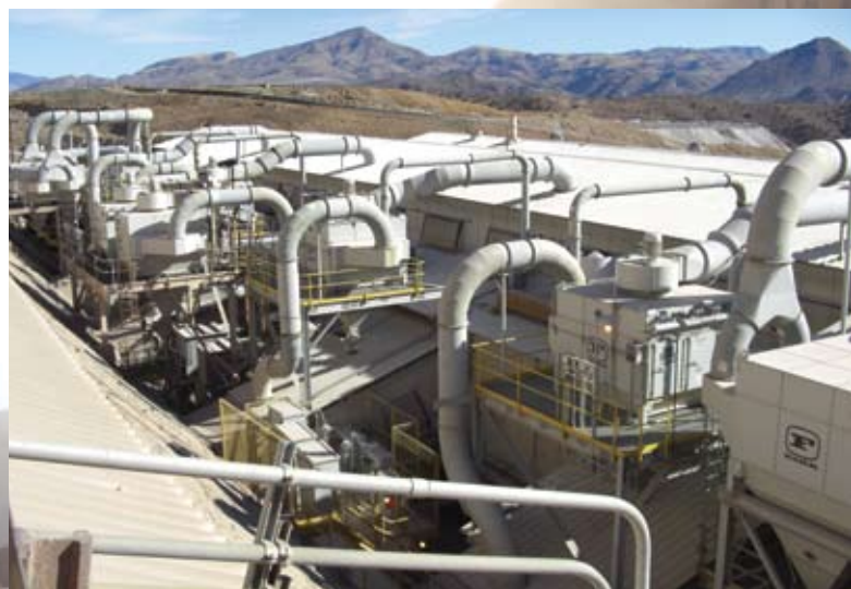
Un GS en una planta secundaria de trituración
